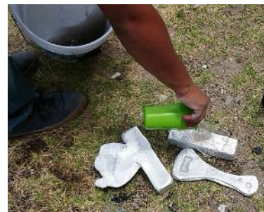
Figura 10. Desmolde y limpieza de las piezas.
