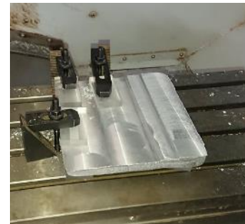
Figura 16. Placa en el proceso de careo (facing).
