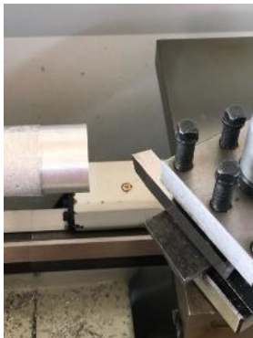
Figura 12. Uso de buriles para el trabajo de carear.
