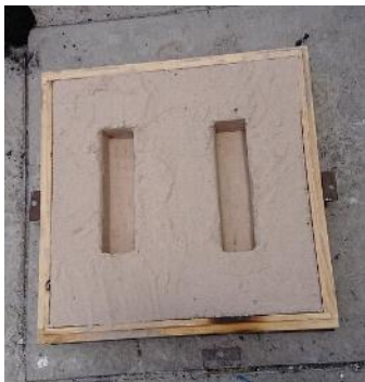
Figura 4. Molde hecho con una pieza real como patrón.
