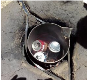
Figura 7. Crisol cargado de latas de aluminio para fundir.
