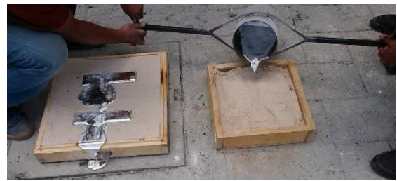
Figura 9. El aluminio líquido se vierte en los moldes.
